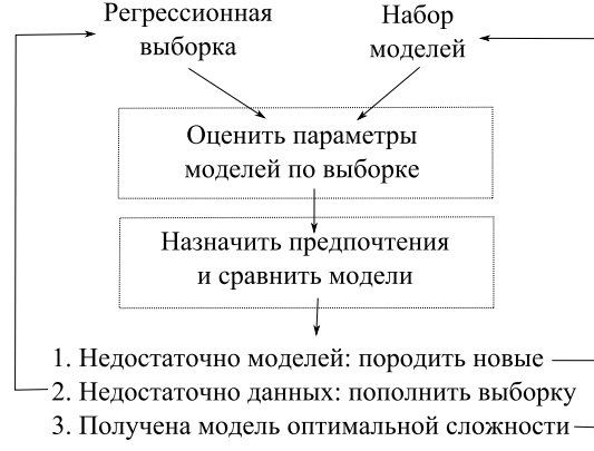
Рис. 44. Использование байесовского вывода при выборе моделей; первый и второй уровень вывода обведены пунктирной линией.
